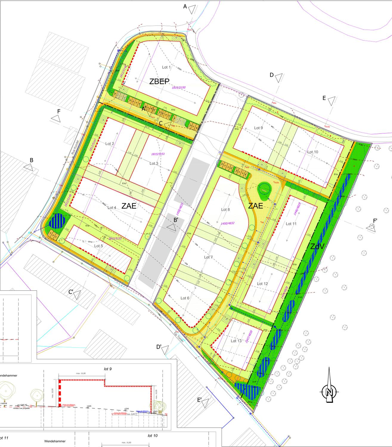
Localisation des points de référence pour la détermination de la hauteur maximale des constructions
